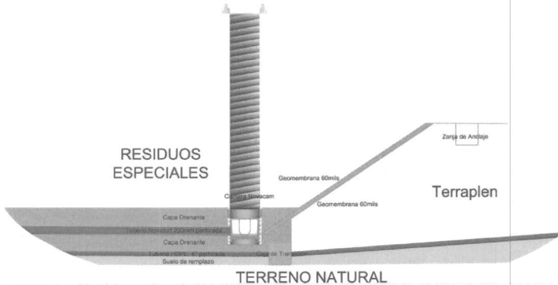
Se colocará doble recubrimiento de geomembrana de 60mils, la primera capa va en la cota batea del tubo del subdren y la segunda en la cota batea del filtro de lixiviados.
